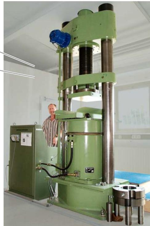
5 MN - Prüfmaschine
